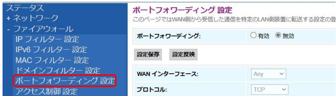
このスクリーンショットは、設定メニューの「ファイアウォール」から「ポートフォワーディング 設定」を選択した状態を示しています。左側のメニューには「ポートフォワーディング 設定」が赤枠で強調されています。右側の設定画面には「ポートフォワーディング」のラジオボタンが「無効」に設定されており、「設定保存」と「設定反映」のボタンが表示されています。また、「WAN インターフェース」が「Any」に、「プロトコル」が「TCP」に設定されています。
