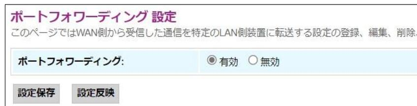
このスクリーンショットは、ポートフォワーディング設定画面の拡大表示を示しています。設定画面の上部には「ポートフォワーディング 設定」というタイトルと、このページでは WAN 側から受信した通信を特定の LAN 側装置に転送する設定の登録、編集、削除が行えることが説明されています。設定画面には「ポートフォワーディング」のラジオボタンが「有効」に設定されており、「設定保存」と「設定反映」のボタンが表示されています。
