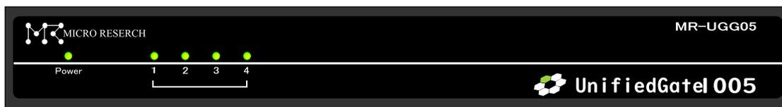
Power : UnifiedGateの電源がONのときに点灯します。
