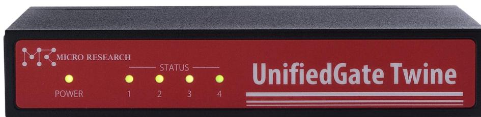
**POWER** : UnifiedGateの電源がONのときに点灯します。
