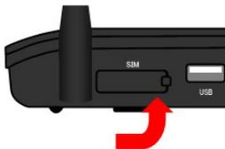
2) SIM カードの切り欠き側を先にして、接点面を下に向けて差し込んで下さい。
