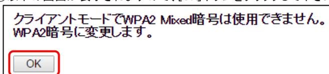
A warning dialog box is shown with the text: 'クライアントモードでWPA2 Mixed暗号は使用できません。WPA2暗号に変更します。' (Cannot use WPA2 Mixed encryption in client mode. Changing to WPA2 encryption.) At the bottom of the dialog, the 'OK' button is highlighted with a red box.
