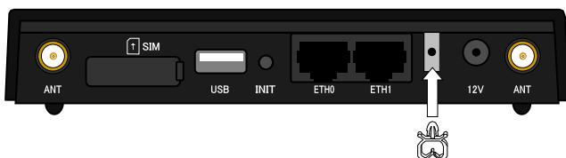
「ANT」端子に内蔵通信モジュール用外部アンテナを取り付けて下さい。
