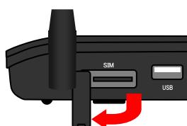
2)SIM カードの接点面を下に向けて挿し込んで下さい。
