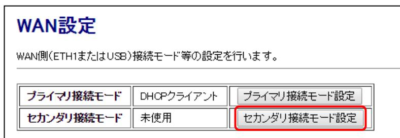
セカンダリ接続で使用するモードに応じて以下の設定を行って下さい。
