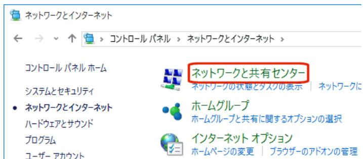
⑤[ネットワークと共有センター]が開きますので、[アダプターの設定の変更]をクリックして下さい。
