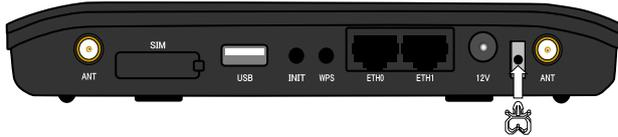
「ANT」端子に内蔵通信モジュール用外部アンテナを取り付けて下さい。
