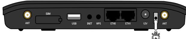
「ANT」端子に内蔵通信モジュール用外部アンテナを取り付けて下さい。
