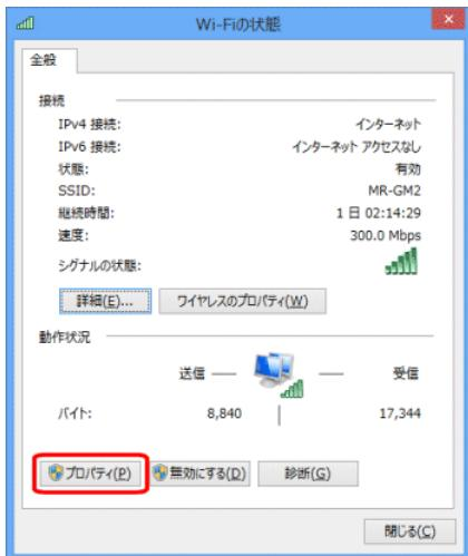
⑰[Wi-Fi のプロパティ]が開きますので、一覧の中の[インターネット プロトコル バージョン 4(TCP/IPv4)]を選択して、[プロパティ]ボタンをクリックして下さい。
