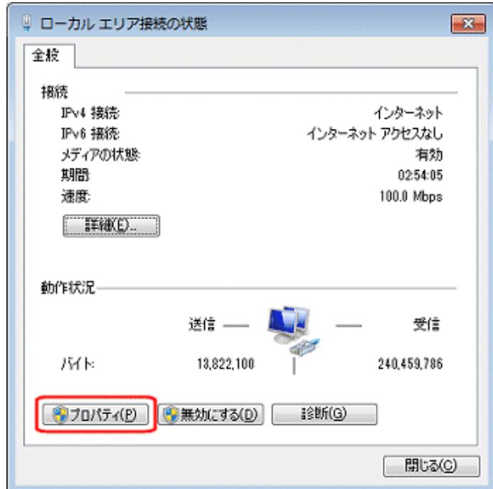
⑦[ローカルエリア接続のプロパティ]が開きますので、一覧の中の[インターネット プロトコル バージョン 4(TCP/IPv4)]を選択して、[プロパティ]ボタンをクリックして下さい。
