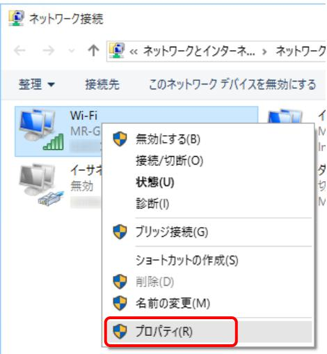
⑭[Wi-Fi のプロパティ]が開きますので、一覧の中の[インターネット プロトコル バージョン 4(TCP/IPv4)]を選択して、[プロパティ]ボタンをクリックして下さい。
