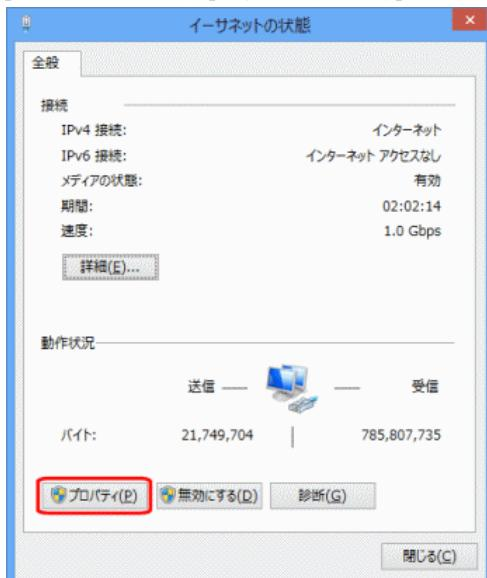
⑧[イーサネットのプロパティ]が開きますので、一覧の中の[インターネット プロトコル バージョン 4(TCP/IPv4)]を選択して、[プロパティ]ボタンをクリックして下さい。
